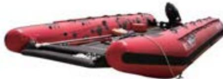
船底キール、チューブ底面には、追加補強が施されており災害現場での救助活動を考慮した構造です。
